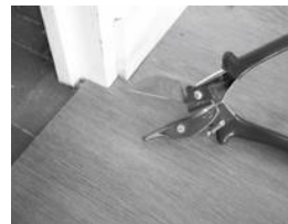
Tesoura de esquadria Nº de ref.: Romus: 93401 / Janser: 237 530 000. Para cortar ao redor da base de molduras de portas e áreas de difícil acesso.
